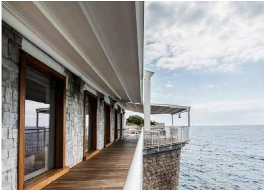
**ES** Palladia® está disponible en la versión inclinada para favorecer la eliminación correcta del agua pluvial, gracias al canalón móvil que la transporta a las bajantes situadas dentro de las columnas y que descargan por el exterior de la estructura.
