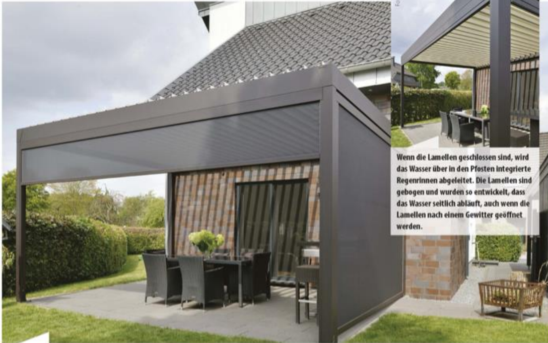
Die Variante Maestro ist eine bioklimatische Pergola mit Aluminium-Lamellen, die über eine Fernbedienung bis zu 140° gedreht werden können. So können die gewünschte Sonnenlichteinstrahlung und Luftmenge jederzeit reguliert werden. Die Senkrechtmarkisen sind in dem 25 cm hohen Rahmenprofil integriert und betonen die filigrane Struktur.
